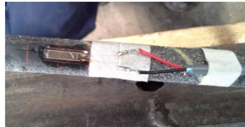
Figura 5. Instrumentación de las barras.
