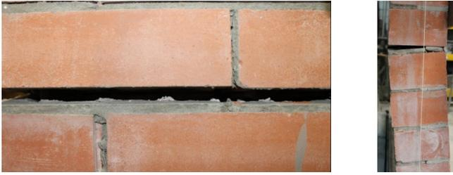
**Figura 13.** Modos de falla típicos en los muros.
