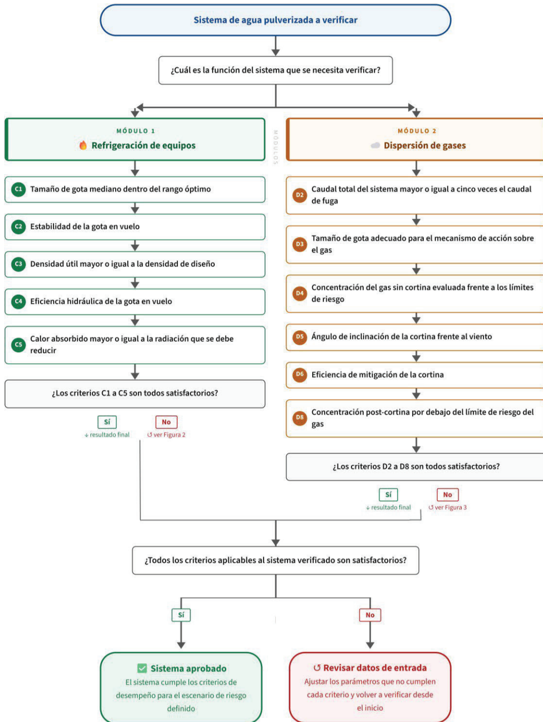
Figura 1 Diagrama maestro. Secuencia de verificación del módulo de refrigeración y dispersión de gases.
